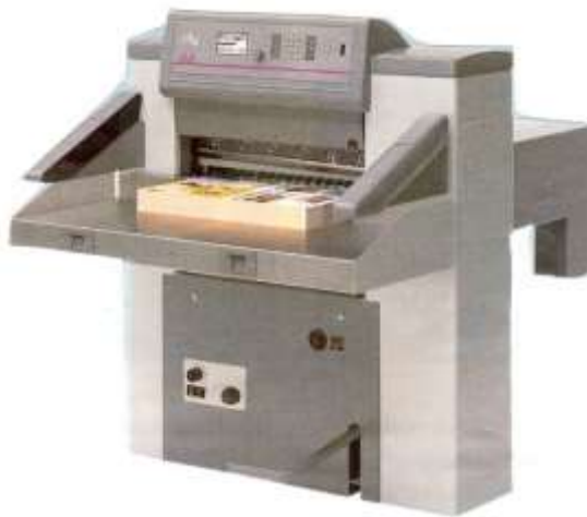
3-расм.Бир пичоқли қоғоз кесиш ускунасининг умумий кўриниши.
