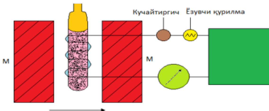
3–rasm. YAMR– spektrometrining umumiy ko‘rinishi.
