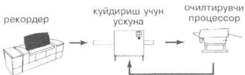
6-расм. Босма қолип тайёрлаш ускуналар комплекси
