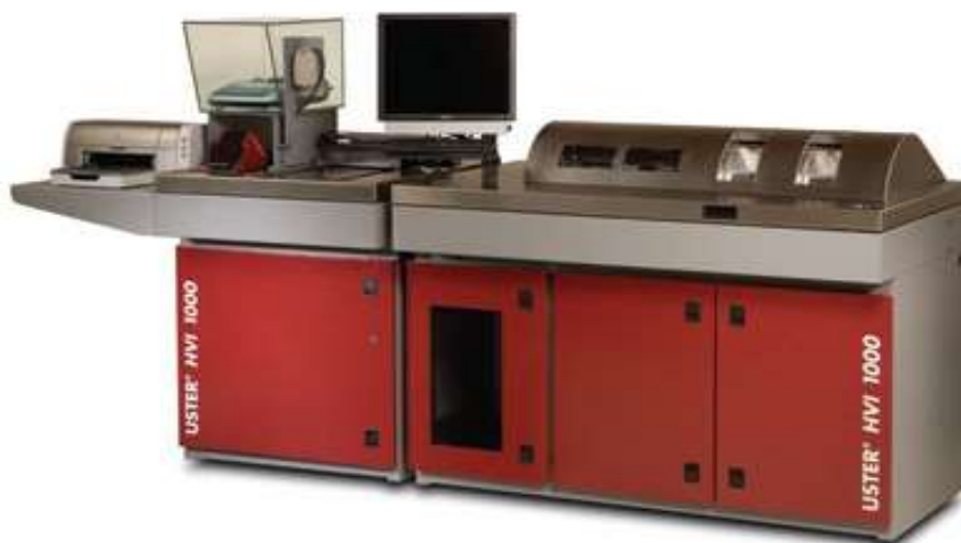
Y015A. Толаларни тараш лаборатория қурилмаси
