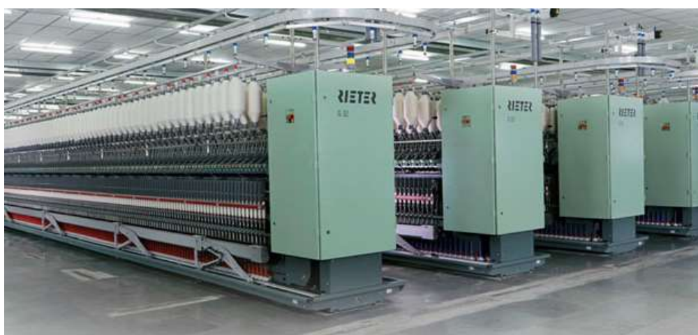
Riter фирмасининг G-32 халқали йигириш машинаси
