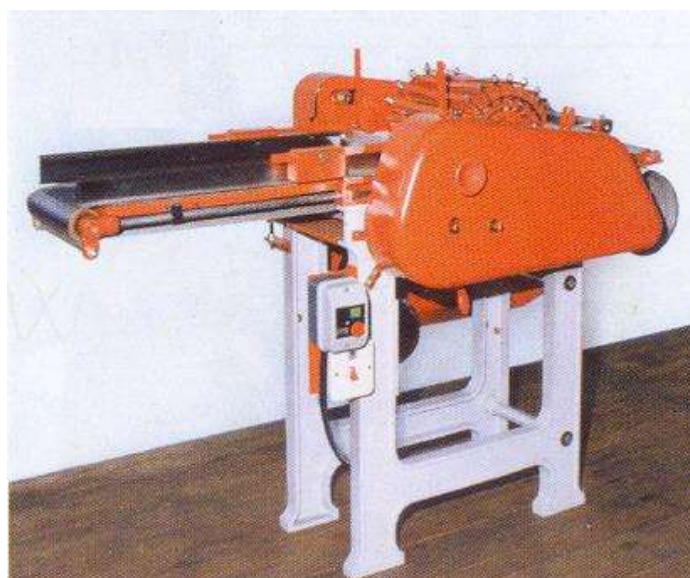
YUFENG10. Ярим автомат пилла чивиш дастгоҳи
