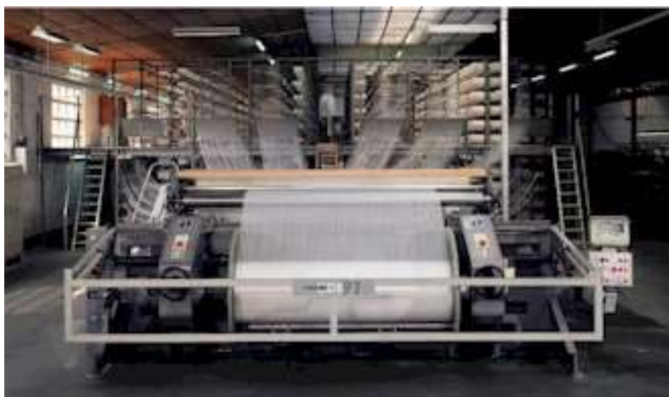
SDB91-300 русумли гуруҳлаб тандалаш машинаси
