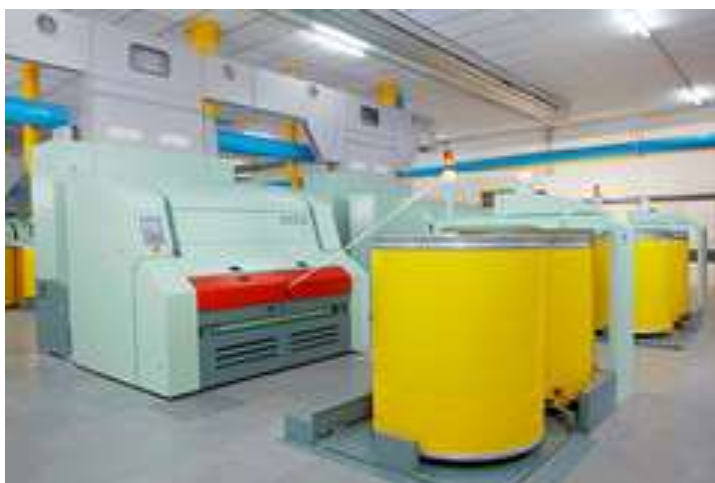
Riter фирмасининг C-70 тараш машинаси
