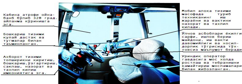
3.1-rasm. Klaas firmasining ARES 816 traktori kabinasida boshqaruv va yordamchi qurilmalarni joylashishi.
