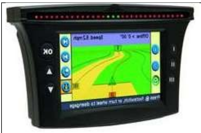
Rasm 5. AgGPS EZ-GUIDE PLUS yoki EZ-GUIDE 500 svetodiod paneli
