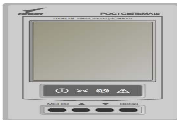
2-rasm. Hosildorlikni davriy ravishda aniqlab borish uchun kombayn kabinasiga o'rnatilgan display
