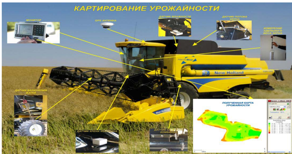
3-рasm. Kombaynda hosildorlikni xaritalash tizimi asboblarning joylashishi va olingan hosildorlik haritasi
