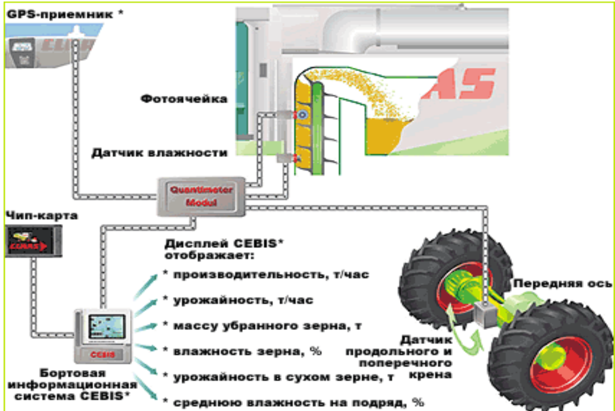
6-рasm. Hosildorlikni monitoringlash tizimi elementlari sxemasi Don oqimi datchiklari
