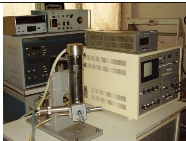
Elektron mikroskop (8-10 нм o'lchamdagi aniqlikda o'lchay oladi.)
