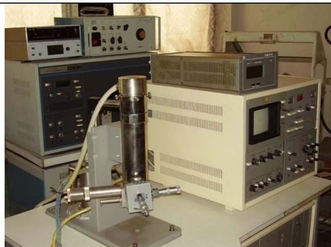
Elektron mikroskop (8-10 nm o'lchamdagi aniqlikda o'lchay oladi.)
