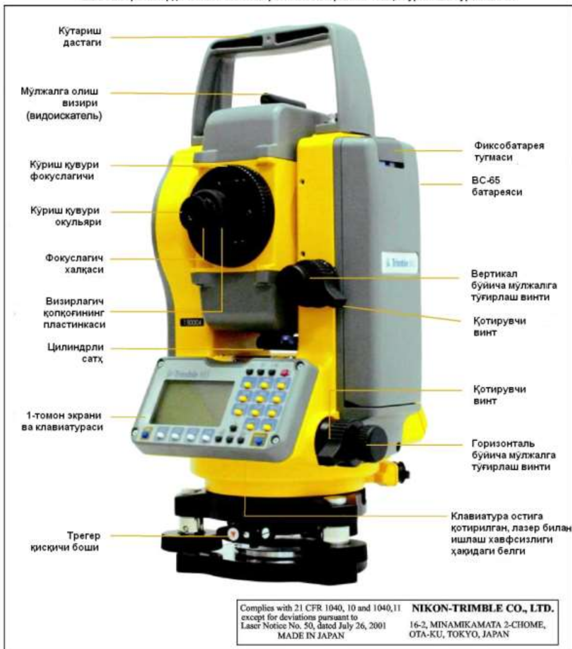
2.2 чизма. Trimble M3 электрон тахеометри - 1- томон (бошқарувчи томони).
