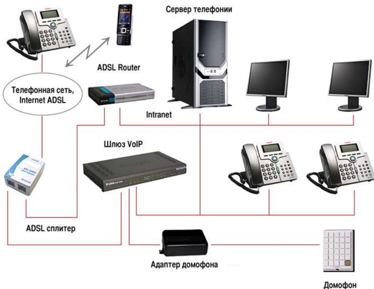
Рис.4.7. Структура офисной связи на базе IP
