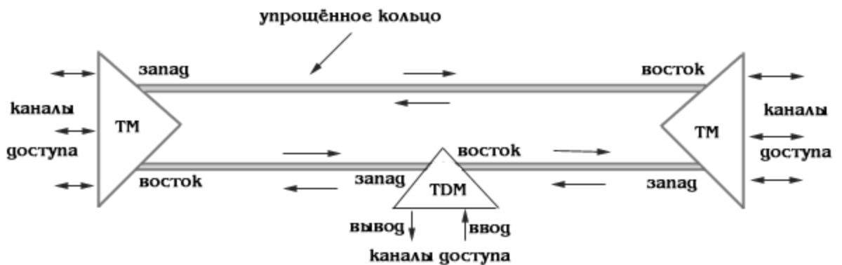
Рис.9.9. Топология "последовательная линейная цепь" типа "упрощённое кольцо" с защитой 1+1.
