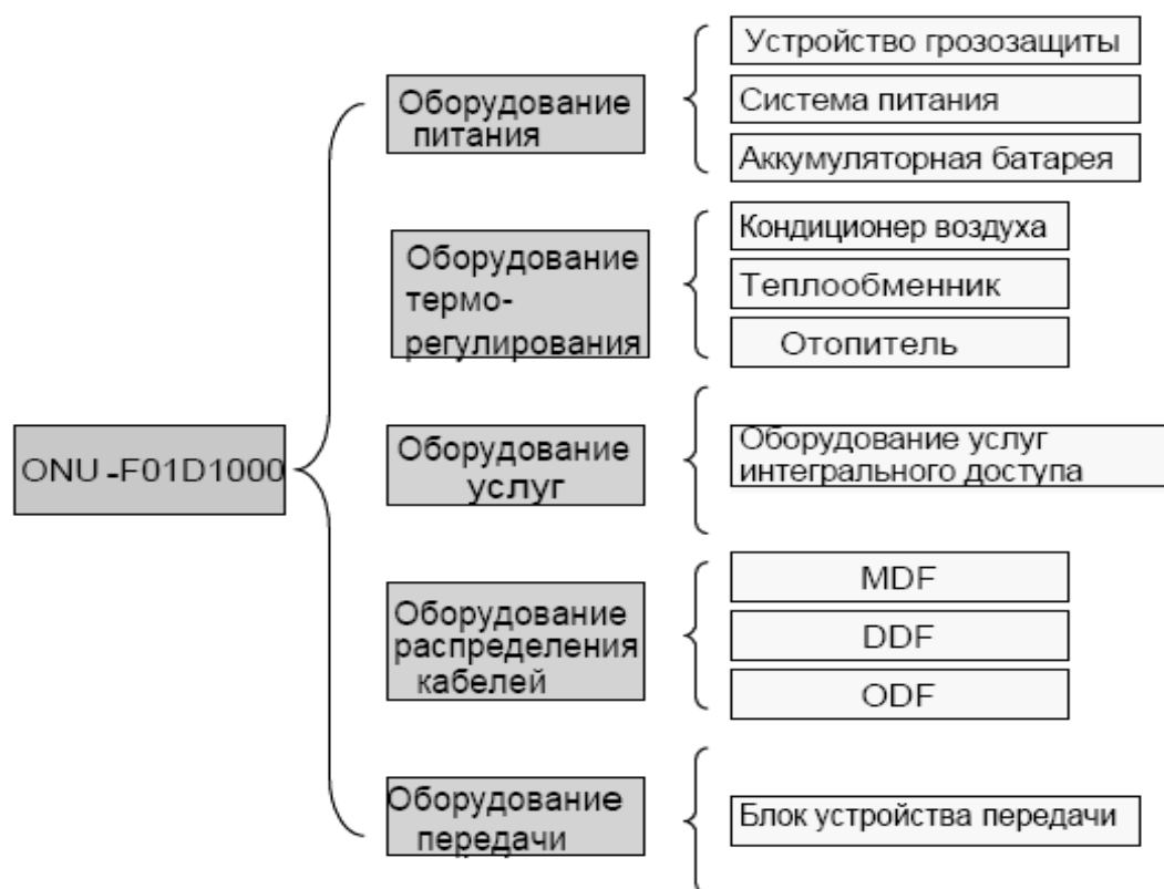
Рис.3.12. MSAN архитектура системы
