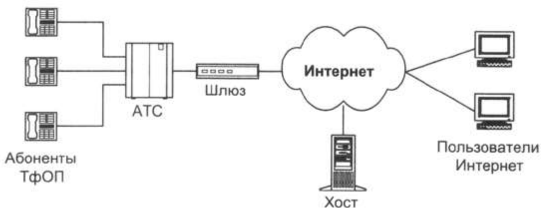
Рис.6.6. Схема связи «WEB-браузер - телефон»
