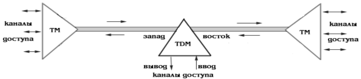
Рис. 9.8. Топология "последовательная линейная цепь", реализованная на TM и TDM
