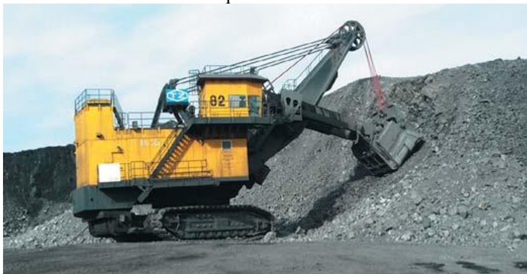
7-rasm. Bachatsk ko'mir razrezida ishlatilayotgan Tayyuanskogo zavodida ishlab chiqarilgan WK-35 ekskavatori
