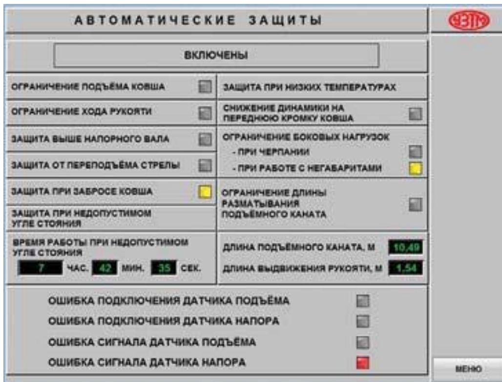
Рasm-10. EKG-12A ekskavatorining ma'lumotlar tizimi ekrani: a – asosiy ekran; b – ishchi uskunalarni avtomatik himoyalash ekrani
