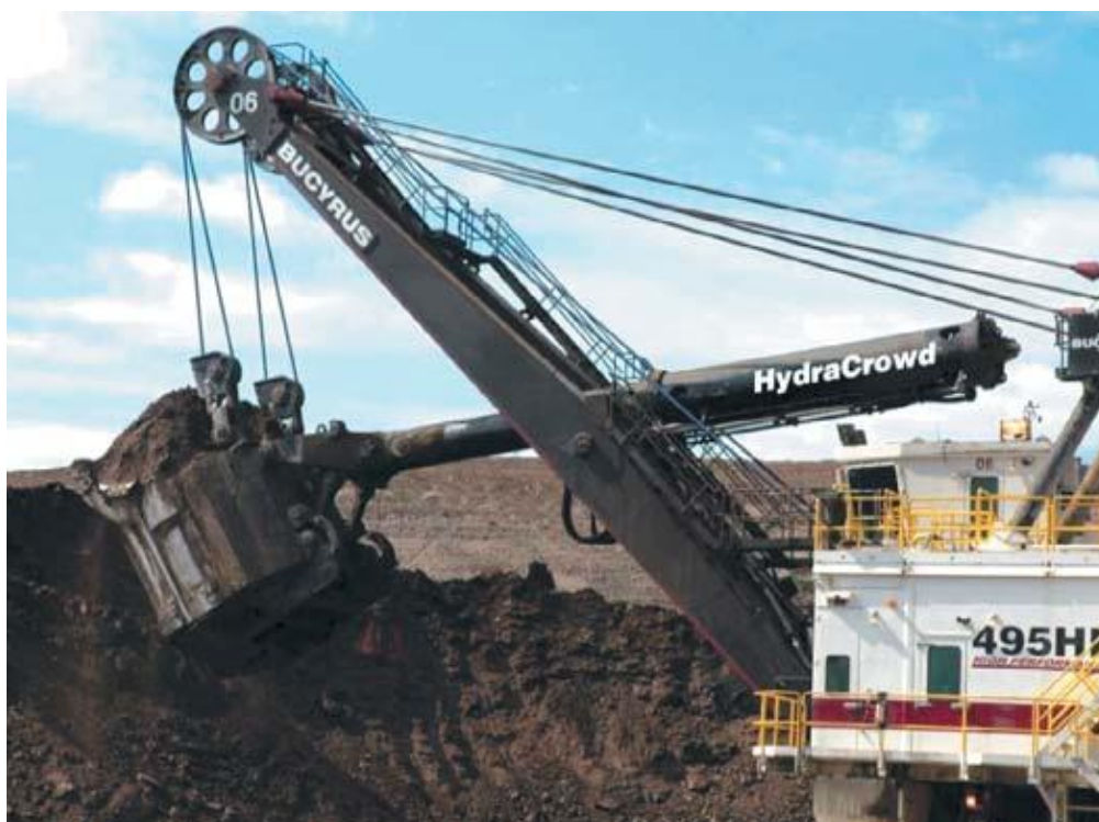
1-rasm. Saterpillar kompaniyasining «HydraCrowd» gidravlik kuch beruvchi mexanizmli 495HF karyer mexanik ekskavatori
