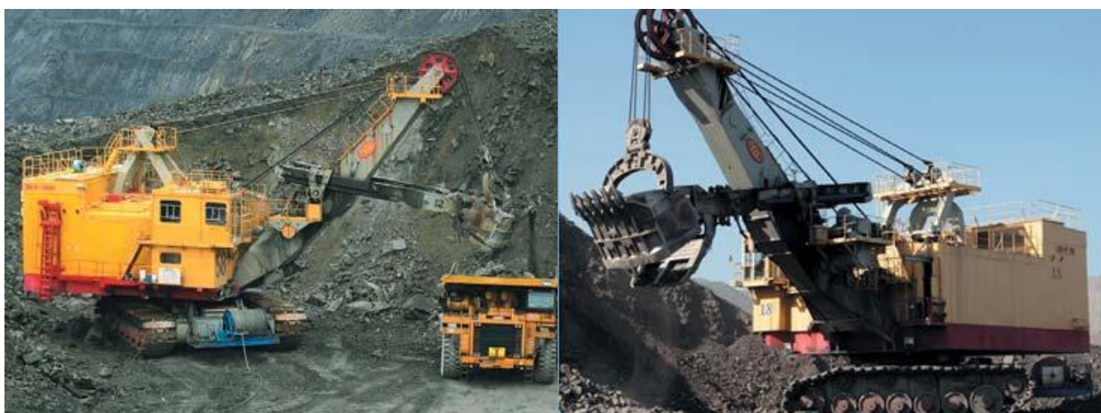
Расм-9. Tishli reykali kuch berish tizimida ishlovchi to'g'ri lopatali ekskavatorlar: a -EKG-12 Chernigovsk razrezida; b - EKG-18 Krasnobrodsk razrezida
