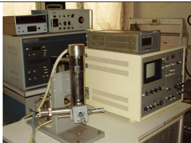
Elektron mikroskop (8-10 nm o'lchamdagi aniqlikda o'lchay oladi.)
