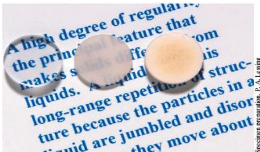
Rasm. 1.2. Alyumin oksididan tayyorlangan uchta ingichka disklar surati
