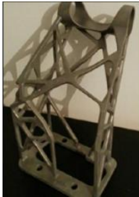
Ti6Al4V EBM tomonidan ishlab chiqarilgan sun'iy yo'ldosh antenasini topologiyani optimallashtirish orqali yaratilgan engil dizayn bilan qo'llab-quvvatlash. (Courtesy of Poly-Shape)
