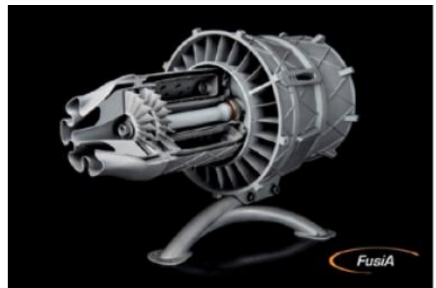
Gaz turbinasi demonstratori (diametri 250 mm va uzunligi 600 mm), funksiyalarni birlashtirish, qismlar sonini kamaytirish, og'irlikni tejash va ishlash uchun Al-, Ti- va Ni-asosli kukunlari bilan selektiv lazer eritish orqali tayyorlangan qismlarni yig'ish orqali (Xushmuomalalik bilan) yasalgan.
