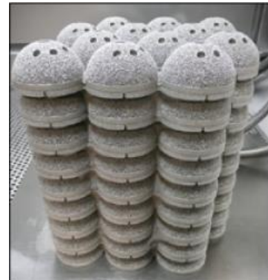
Osseointegratsiyani yaxshilash uchun yuqori o'ziga xos sirt dizayniga ega Ti6Al4V implant (asetabulyar chashka). (Courtesy of ARCAM)
