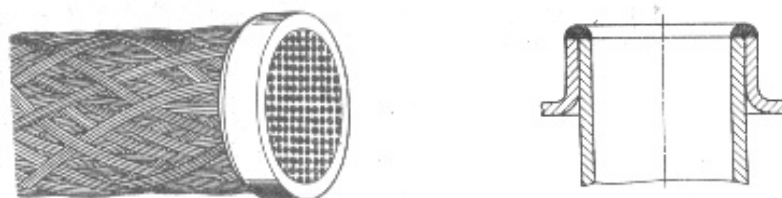
5-rasm. Ftoroplast trubali issiqlik almashinish elementi.
