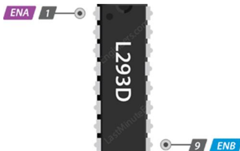
1.10- rasm. Tezlikni boshqarish pinlari
