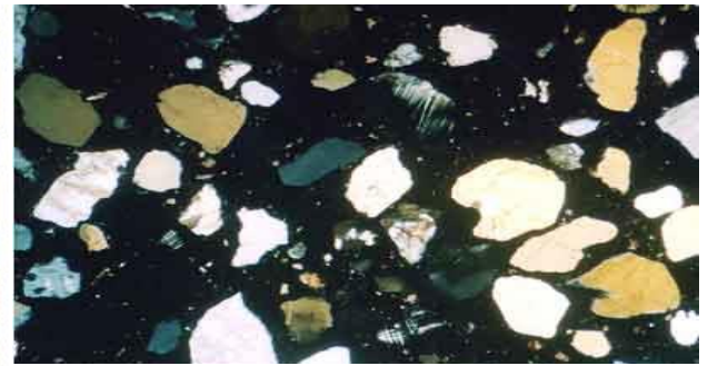
7-Rasm B. Sement plitkasini mikrorasmlari – qora rangdagi asosiy massa – magnezial sement, yirik donali oq rangli zarrachalar – dala shpatlari, slyudalar tarkibida tutgan qum minerallari, kattalashtirish darajasi 25x. O'tqazuvchi nur, nikollar kesishga holda.
