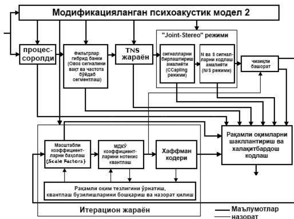
3.9-расм. ISO/IEC 13818-7 стандартининг MPEG-2 AAC кодерининг ташкилий чизмаси ва унинг кўпканалли шакли
