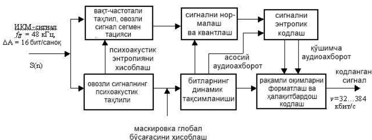
1.13-расм. Аудио маълумотларни сиқувчи кодернинг умумий тузилиш схемаси.
