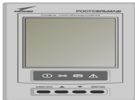
2-расм. Ҳосилдорликни даврий равишда аниқлаб бориш учун комбайн кабинасига ўрнатилган дисплей
