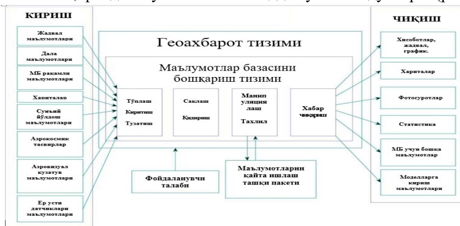
1-расм. Геоахборот тизимлари функцияланишининг умумий схемаси
