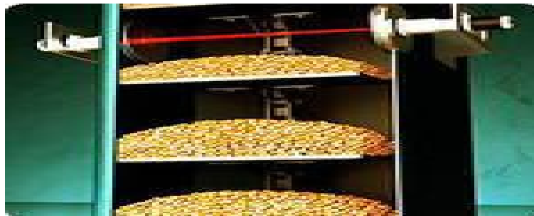
10-расм. Дон миқдорини ҳажм бўйича аниқлаш датчиги
