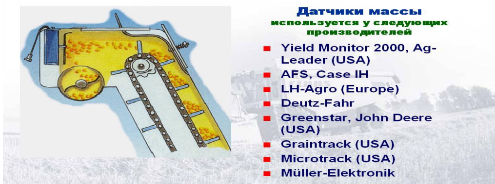
7-расм. Ғалла комбайни бункеридаги элеваторга дон оқими зарба кучини сезувчи датчикни жойлаштиш схемаси
