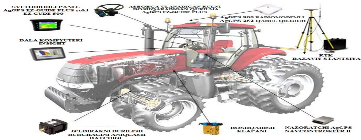
5-расм. Параллел ҳаракатланиш ва автопилотлаш қурилмаларининг тракторда жойлашиши
