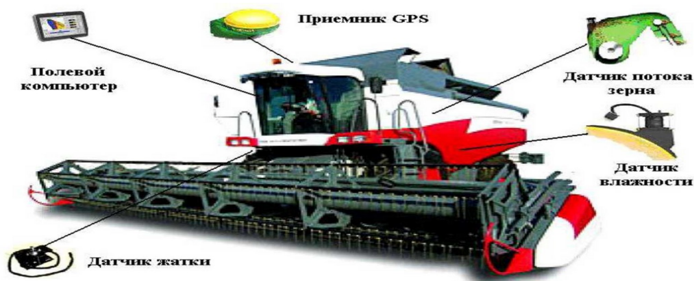
2-расм. Ҳосилдорликни мониторинглаш тизими жиҳозларининг ғалла комбайнида жойлашиши
