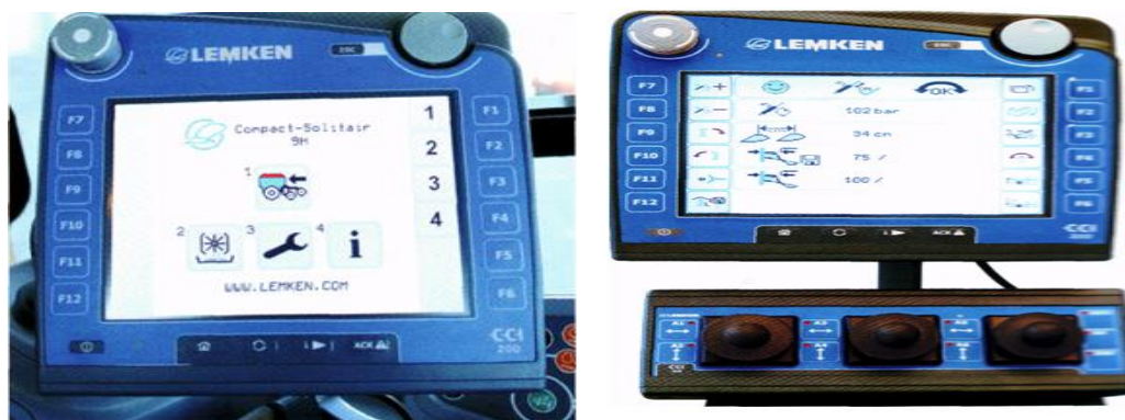
3.5-расм. Белгилар ва пиктограмма қурилмаси (а) ва плугни бошқариш учун джойстли ССИИСОБУС терминали (в)
