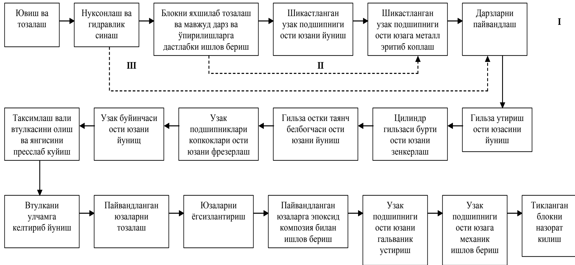
44–расм. Цилиндрлар блокни тиклаш маршрут технологик жараёни.
