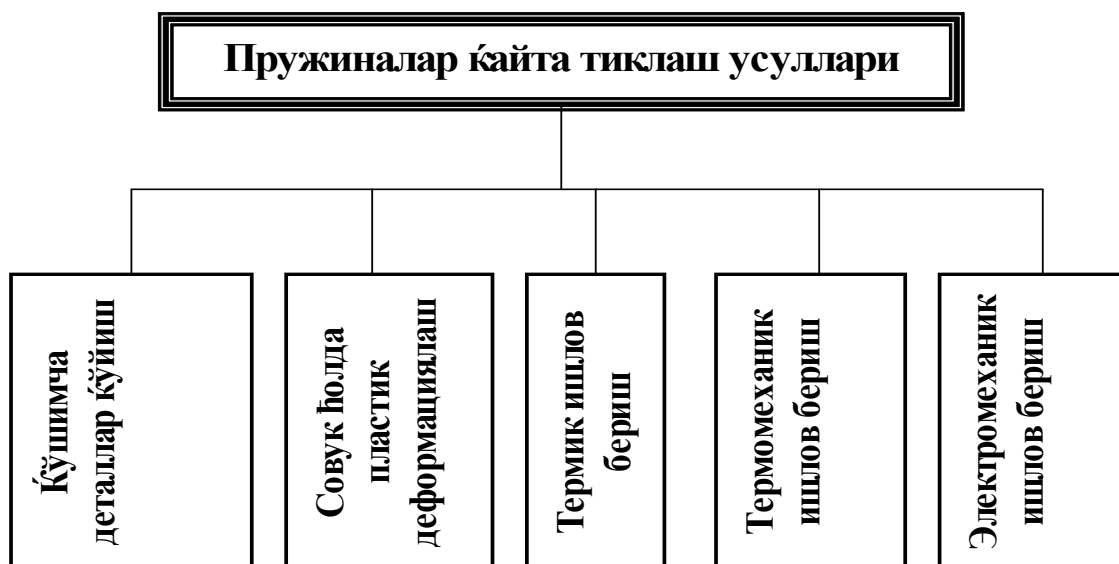
54-расм. Пружиналарни қайта тиклаш усуллари
