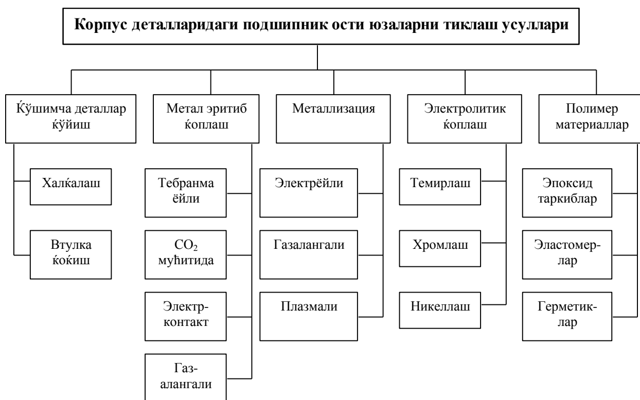
46–расм. Узатмалар кутиси подшипник ости юзаларни тиклаш усуллари классификацияси
