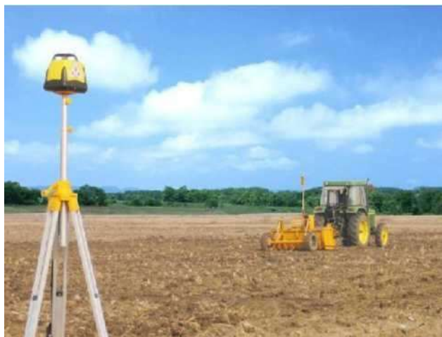
ARES 697 ATZ ғилдиракли трактори туркамасида лазерли ер текислаш
