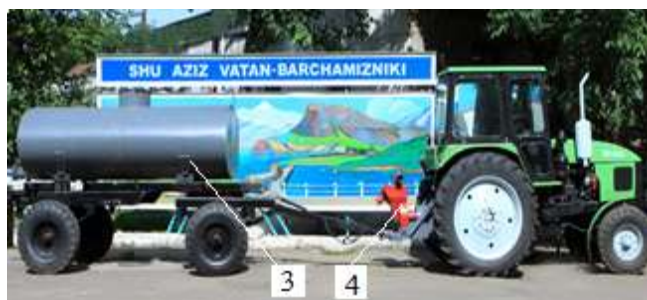
11 – расм. ПДТ-200 дренаж ювиш машинаси.
