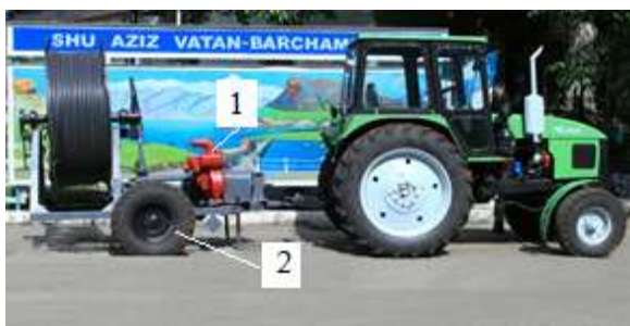
11 – расм. ПДТ-200 дренаж ювиш машинаси.
