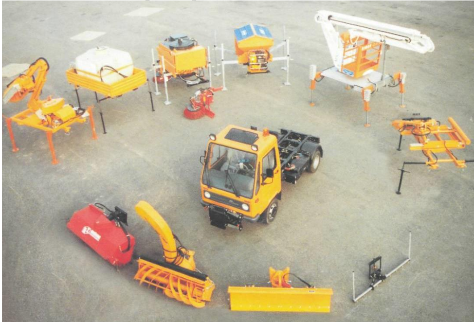
4.2-rasm. Multicar bazaviy avtomobili va unga o'rnatish mumkin bo'lgan ishchi agregatlar
