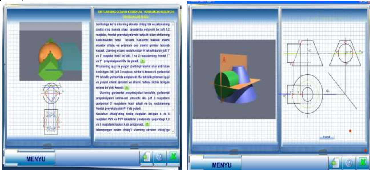
1.6-рasm. Шар ва призманинг ҳамда конус ва цилиндрнинг ўзаро кесишиш чизиғини аниқлаш анимацияси
