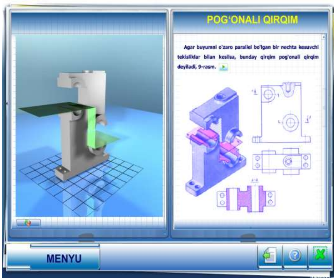
1.11-расм. Поғонали қирқимни ҳосил қилиш учун деталнинг текислик билан хаёлан кесилиши анимацияси
