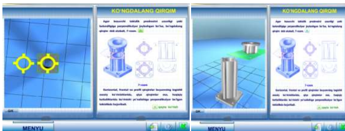
1.12-расм. а) Детални хаёлан кесиш орқали кўнгдаланг қирқимни ҳосил қилиш анимацияси; б) кесим ва қирқимни солиштириш
