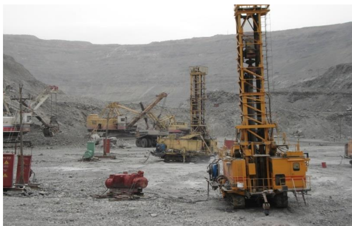
1. Rasm. Karyerlarda sharoshkali burg'ulovchi stanok yordamida skvajinalarni burg'ulash.
