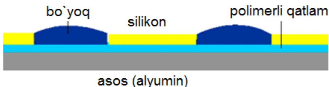
6-rasm. Quruq ofset uchun qolipnaning tuzilishi
