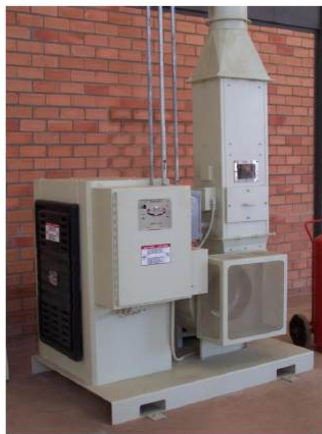
1 MBTU gaz bilan ishlaydigan burner / ventilyator majmuasi
