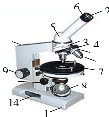
3-rasm. MIN-8 markali polarizatsion mikroskopning ko'rinishi.
