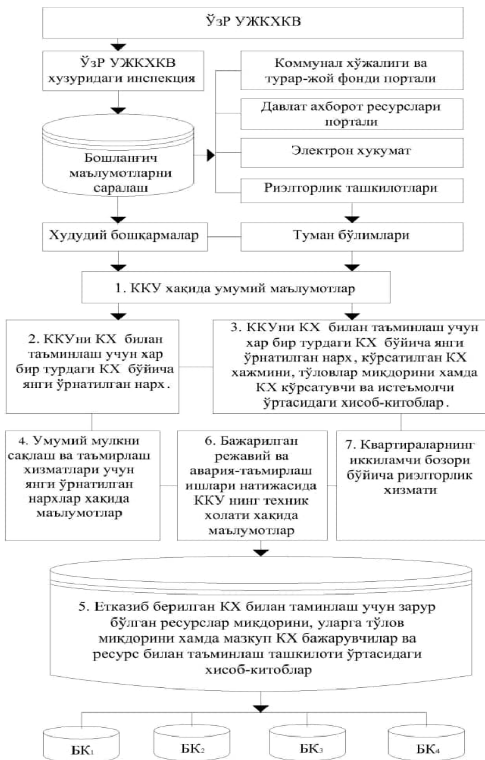
1.15-rasm. KКУ ekspluatatsiyasi sifatini oshirish bo'yicha elektron pasport shaklida monitoring tizimining tarkibiy tuzilishi [130].
