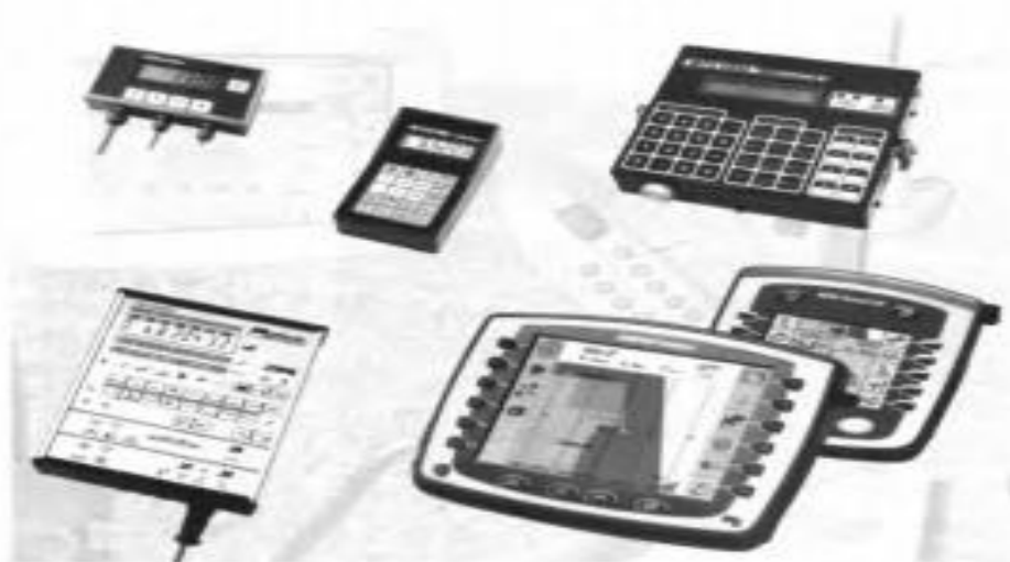
4.2-расм. Борт компьютерининг вариантлари: оддий Nektarzahler (юқорида чапдаги) Комфорт-Терминал ISO-BU Мюллер-электроника учун ва John Deere компанияси трактори компьютерлари.
