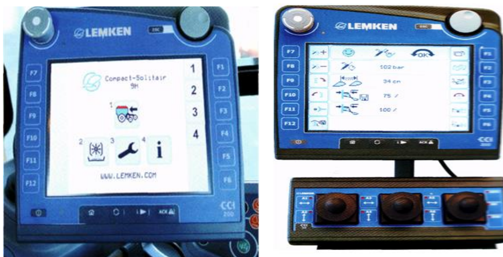
3.5-расм. Белгилар ва пиктограмма қурилмаси (а) ва плугни бошқариш учун джойстли CCI ISOBUS терминали (в)
