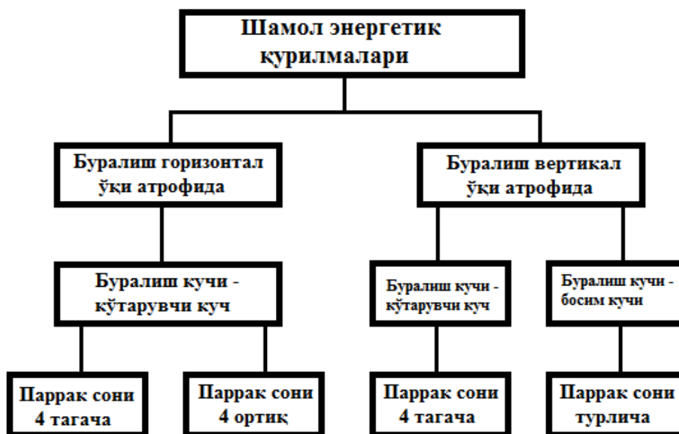
1.3-расм. Шамол энергетик қурилмаларни классификацияси.
