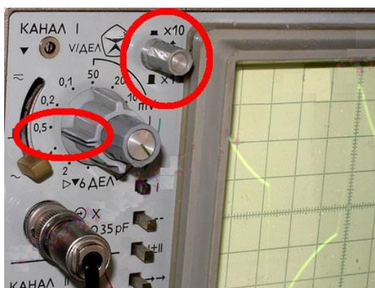
2.5 - расм. С1-83 осциллографда вертикал бўйича масштабни аниқлаш.
