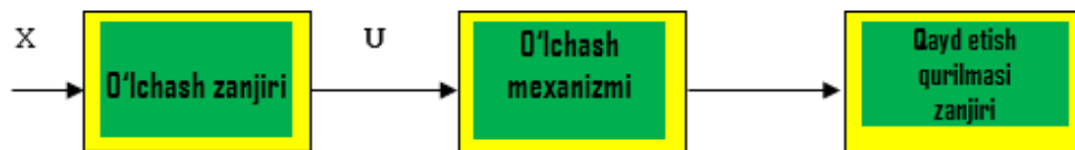
2.1-расм. Аналогли ўлчаш асбобининг структура схемаси.
