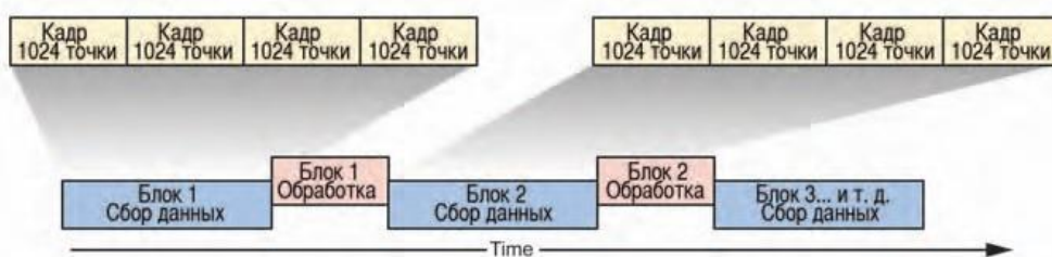
3.10-расм. Реал вақт ўлчамида спектр анализатори ёрдамида маълумотлар блокларини рўйхатга олиш ва қайта ишлаш
