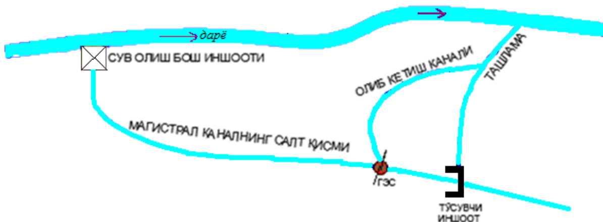
26-rasm. Magistral kanalning nishabligi daryo nishabligidan kichik bo'lgan ( I_{mag.kanal} < I_{daryo} ) holatda energiya ishlab chiqarish sxemasi.
