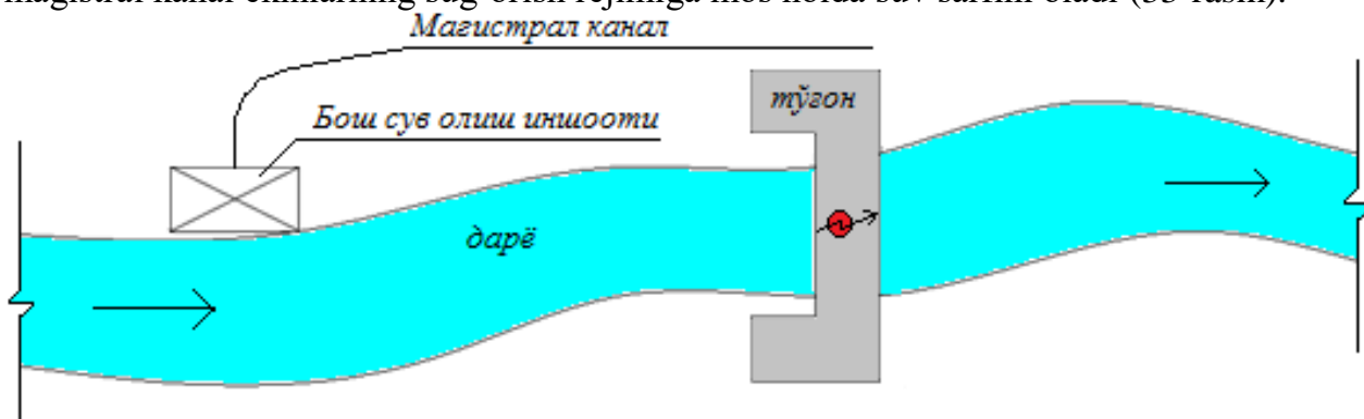
33-rasm. Daryodagi suv sathini ko'taruvchi to'g'onga qurilgan GES sxemasi.
