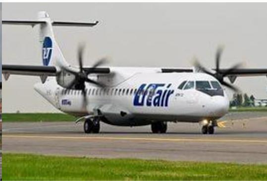
**ATR-72** пассажирский двухмоторный турбовинтовой самолёт для среднемагистральных перелётов. Самолёт предназначен для перевозки до 74 пассажиров одного класса на средние расстояния и управляется двумя пилотами.
