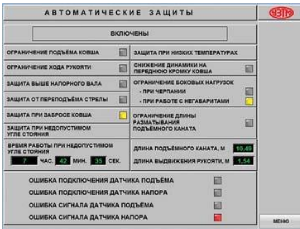
Rasm-10. EKG-12A ekskavatorining ma'lumotlar tizimi ekrani: a – asosiy ekran; b – ishchi uskunalarni avtomatik himoyalash ekrani
