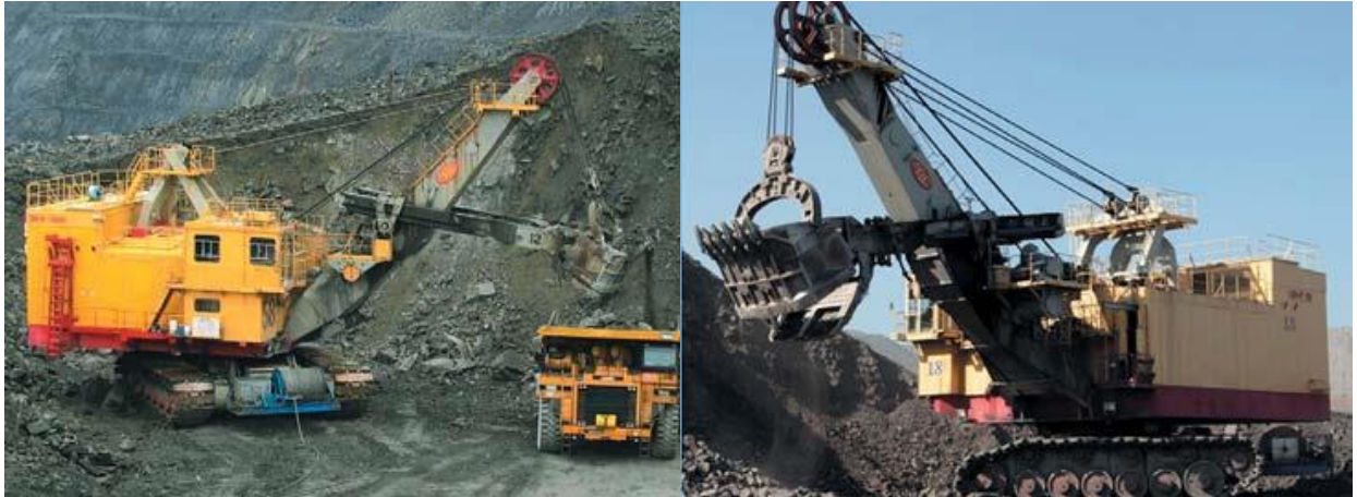
Рasm-9. Tishli reykali kuch berish tizimida ishlovchi to'g'ri lopatali ekskavatorlar: a -EKG-12 Chernigovsk razrezida; b - EKG-18 Krasnobrodsk razrezida
