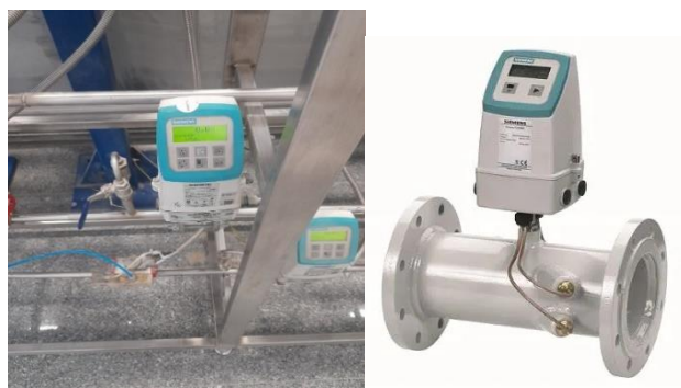
2-rasm. SIEMENS SITRANS F M MAG 5000/6000 elektromagnitniy raqamli sarf o'lhagichi etalon qurilmasiga urnatilishi.
