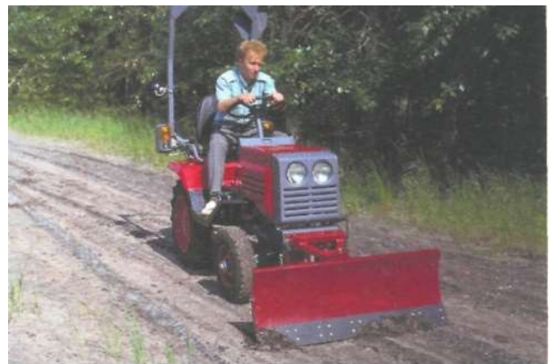
5.1-rasm. Mini traktor KMZ-012 yordamida qoplamani tozalash
