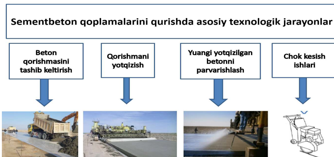
2.30-rasm. sementbeton qoplamalarini qurishda texnologik jarayonlari
