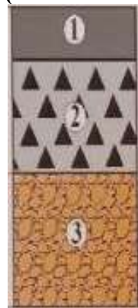
2.13-rasm. 1-mayda donali zich issiq asfaltbeton; 2-sement bilan ishlov berilgan chaqirtosh-qum qorishmasi; 3-qum-shag‘al qorishmasi.
