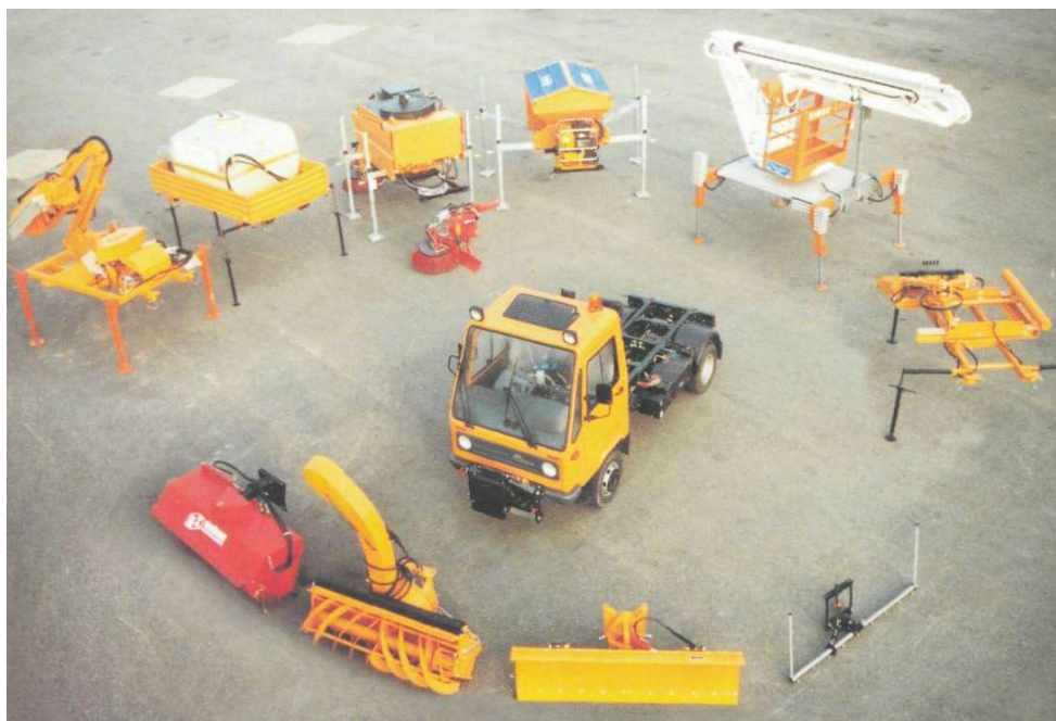
5.2-rasm. Multicar bazaviy avtomobili va unga o'rnatish mumkin bo'lgan ishchi agregatlar
