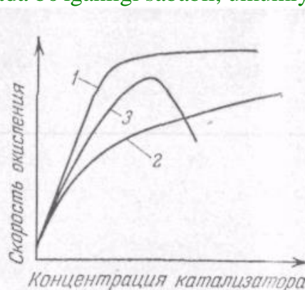
Рис. 93. Влияние концентрации катализатора на скорость жидкофазного окисления парафинов с \text{Co}^{2+} (кривая 1) и с \text{Mn}^{2+} (кривая 2) и алкилароматических углеводородов с \text{Co}^{2+} (кривая 3).
