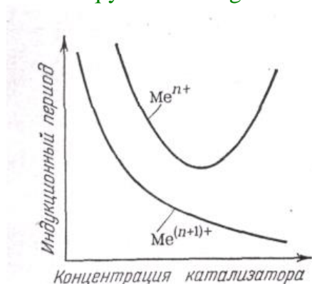
Рис. 90. Влияние концентрации катализатора на длительность индукционного периода окисления.
