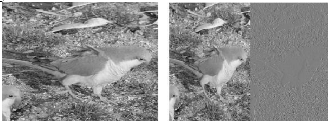
2.8-rasm. Daslabki tasvir va satrlar bo‘yicha veyvlet – dekompozitsiyasidan so‘ng
