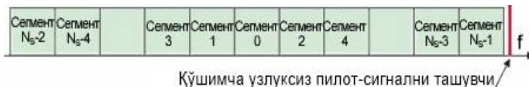
4.20-rasm. Uzatilayotgan radiosignal spektri ( N_S -segmentlar miqdori)
