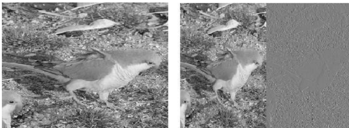
3-rasm. Daslabki tasvir va satrlar bo‘yicha veyvlet – dekompozitsiyasidan so‘ng
