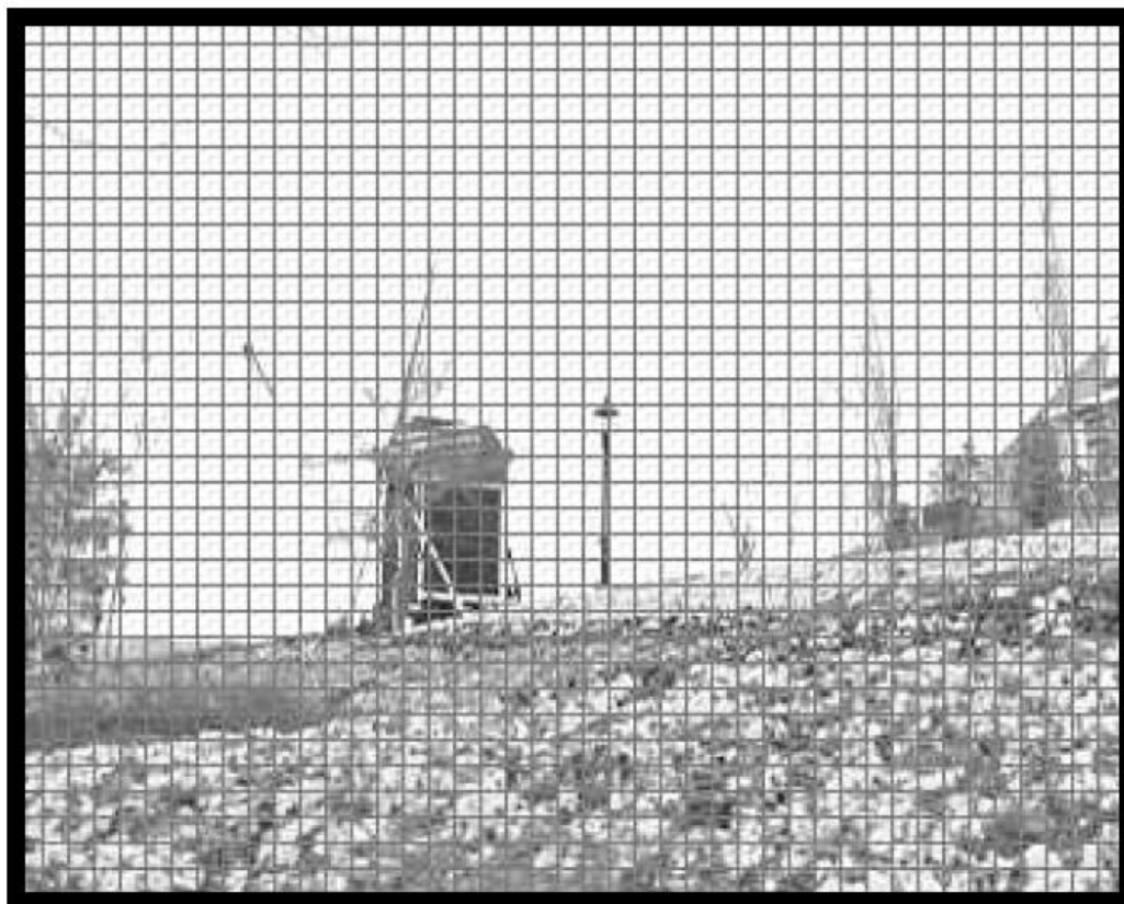
3.16.rasm. Tasvirning blok va makrobloklarga bo'linishi.
