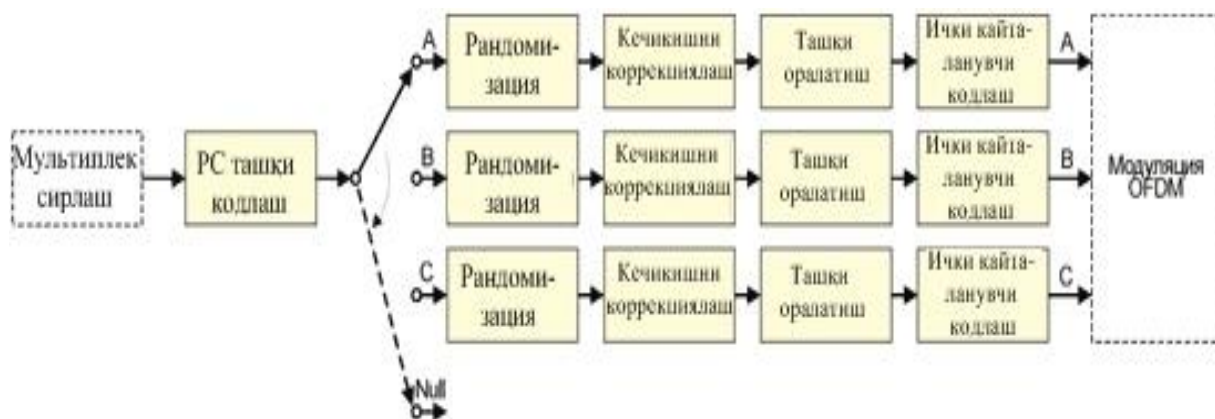
4.19 – rasm. ISDB tizimida ma'lumotlarni kanalli kodlash.
