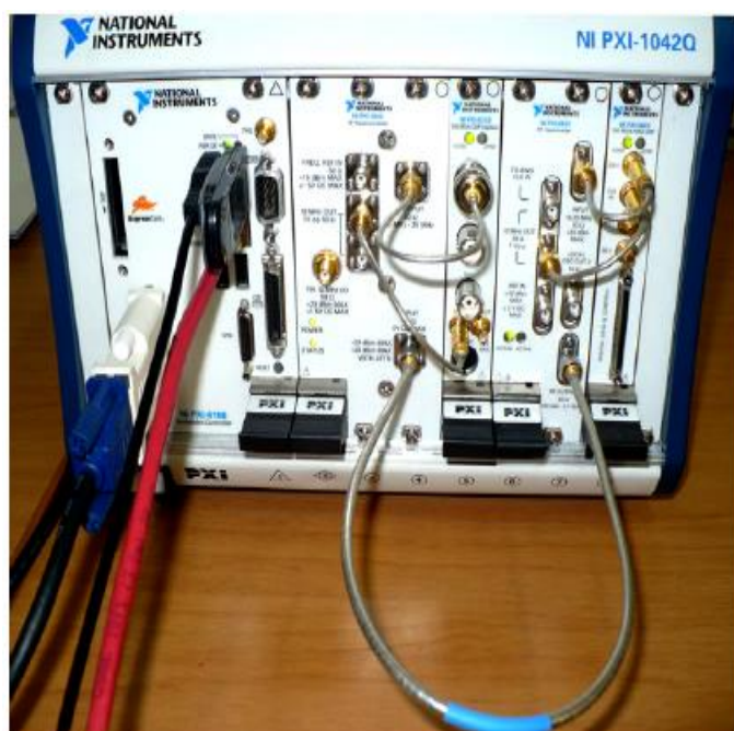
1-rasm. Tizimning maxsus kabel (a) va antenna (b) yordamida ulanish sxemasi.
