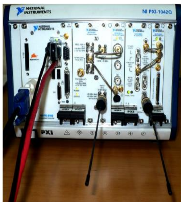
1-rasm. Tizimning maxsus kabel (a) va antenna (b) yordamida ulanish sxemasi.
