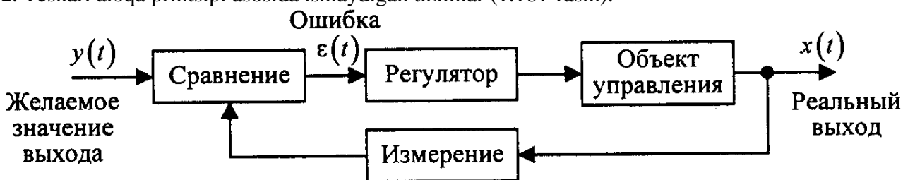
-rasm. Qayta aloqa bilan ART ning funktsional diagrammasi
