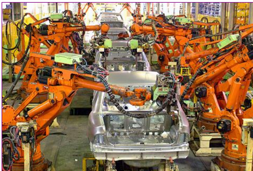
1.3-rasm. Avtomobil organlarining ommaviy-ishlab chiqarish liniyasi
