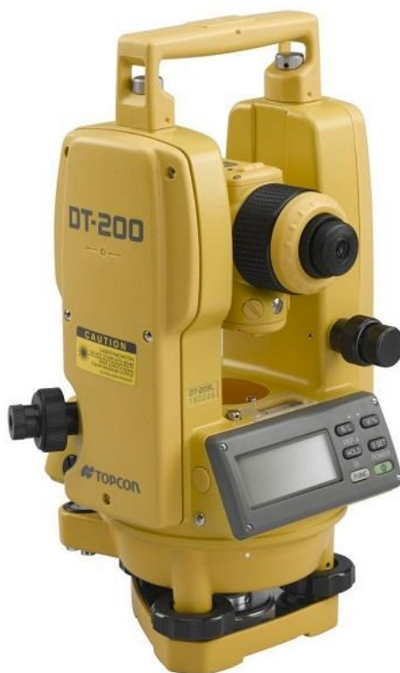
1-rasm. Geodezik-marksheyderiya sohasida keng qo'llaniladigan yuqori aniq optik-elektron taxeoetr
