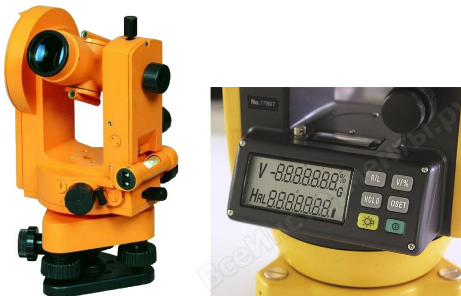
1-rasm. Yuqori aniq optik-elektron asboblarda suyuq kristalli displeyida ma'lumotlarni ko'rinishi
