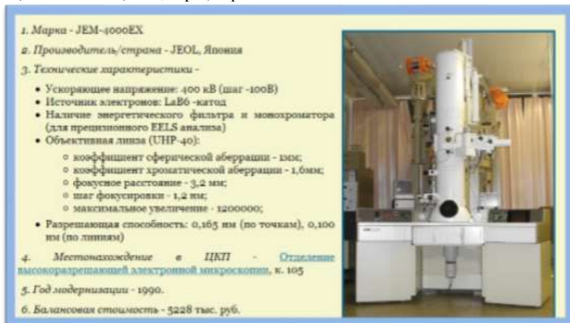
15-Расм. JEM-400EX (JEOL, Japan) электрон микроскопининг кўриниши ва техник кўрсаткичлари.
