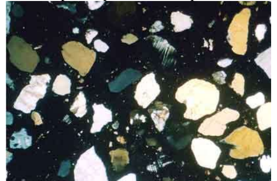
13-Расм Б . Цемент плиткасини микрорасмлари – қора рангдаги асосий масса – магнезиал цемент, йирик донали оқ рангли заррачалар – дала шпатлари, слюдалар
