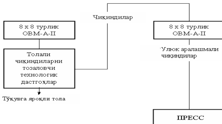
15-rasm. Tolali chiqindilarni tozalashning texnologik sxemasi
