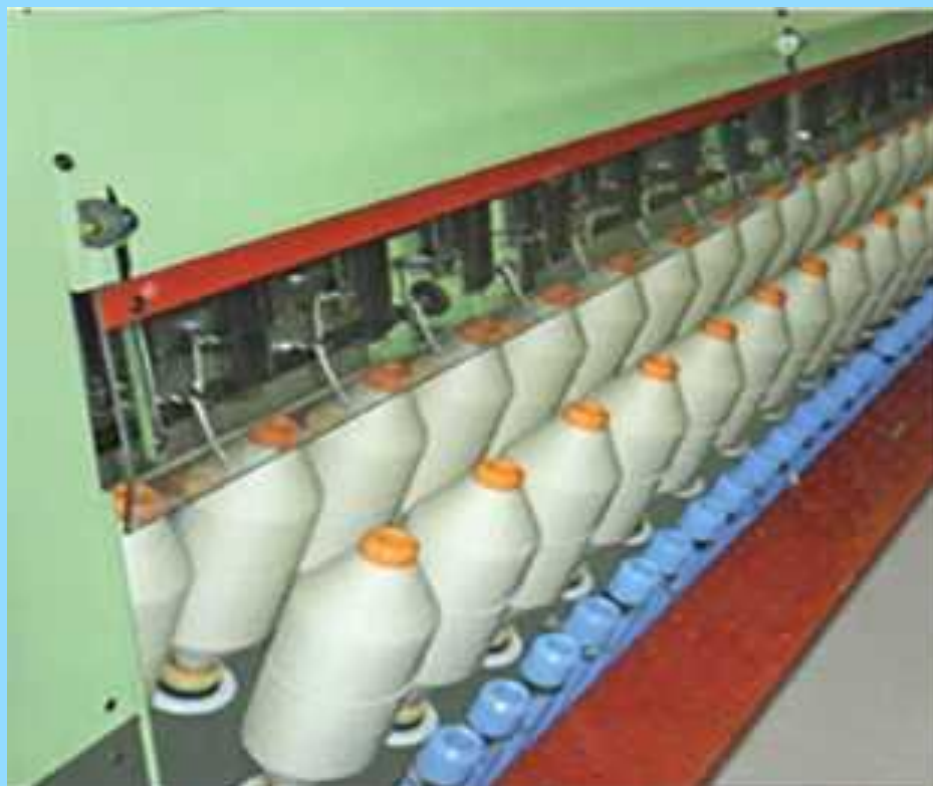
2.8-rasm. G'altak novini og'dirib qo'lda syomga tayyorlash
