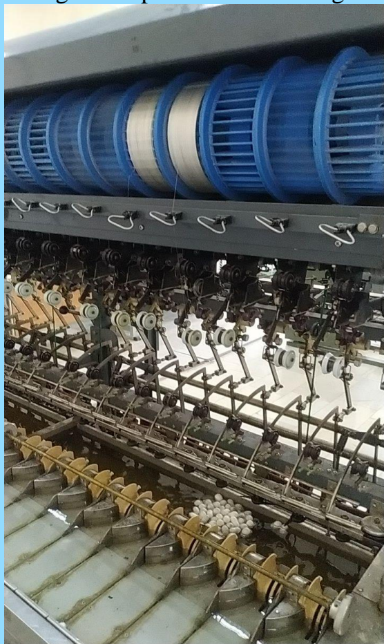
2.3-rasm. Harada avtomat pilla chuvish dastgohida yuqori chiziqli zichlikdagi xom ipak chuvish jarayoni
