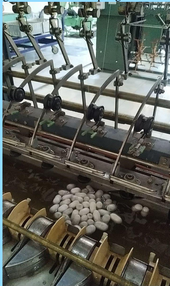
2.3-rasm. Harada avtomat pilla chuvish dastgohida yuqori chiziqli zichlikdagi xom ipak chuvish jarayoni
