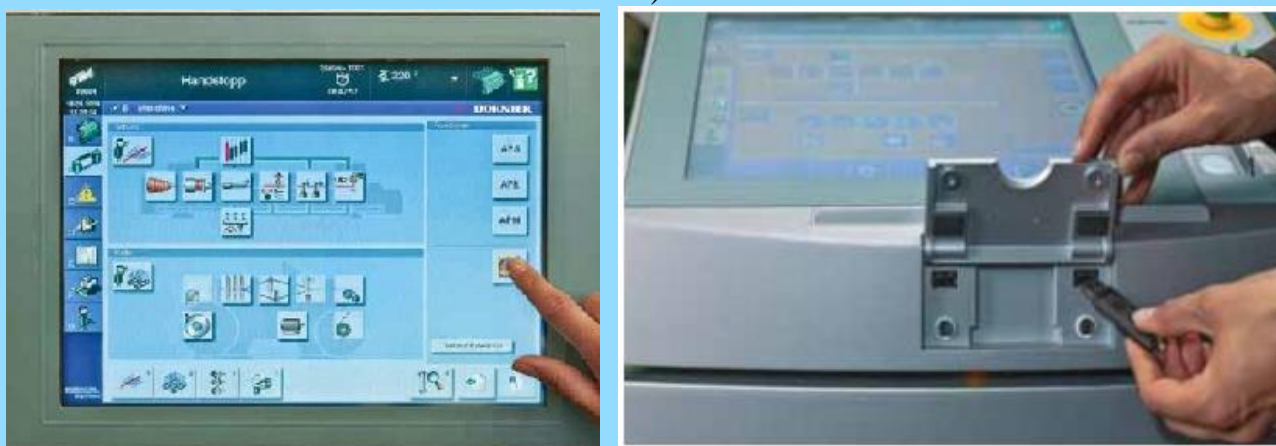
3.2-rasm. Somet a) va Dornier b) to'quv dastgoxlarini elektron nazorat paneli
