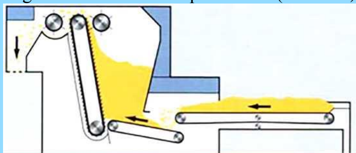
1.3-rasm. BO-S tituvchi mashina sxemasi
