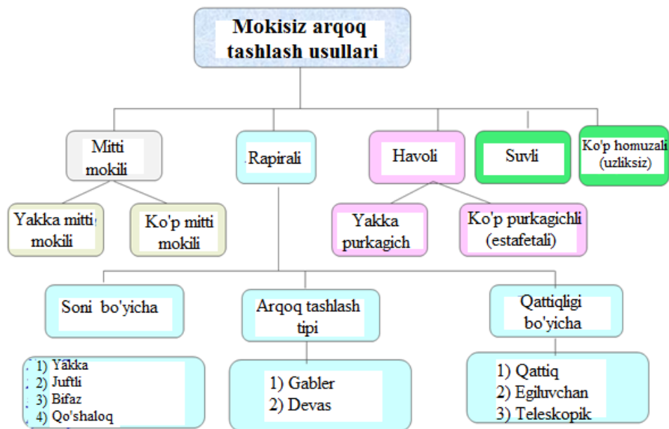
1-rasm. Mokisiz arqoq tashlash usullari
