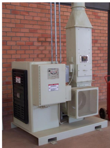
1 MBTU gaz bilan ishlaydigan burner / ventilyator majmuasi
