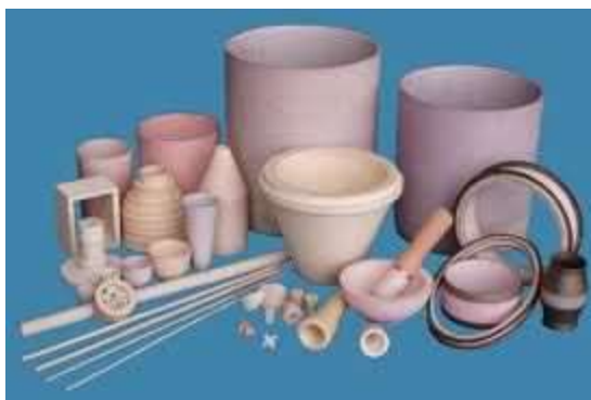
4-расм. Алюмосиликатдан тайёрланган оловбардош буюмлар (тигель, лодочка, трубкалар).
