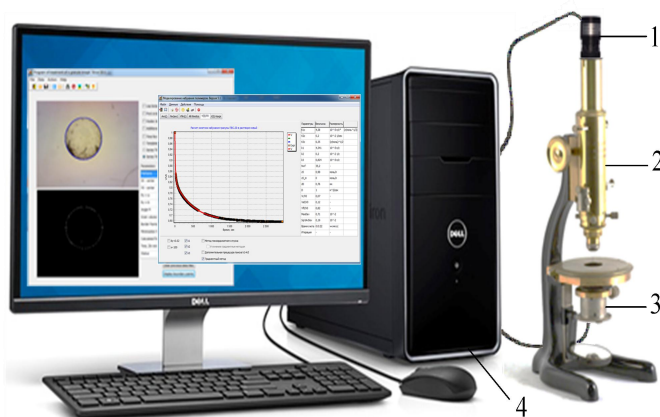
Расм-5. Оптик микрометрия усулда полимер гел бўкишини аниқлаш асбоби. 1 – видеокамера; 2 – оптик микроскоп; 3-ячейка; 4- дастурлар пакети билан жиҳозланган ПК.
