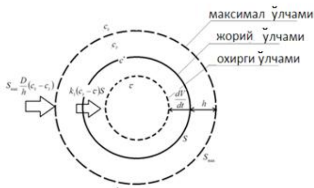
Расм-4. Полимер материаллар гранулалари ичида ва ташқарисида эритма концентрациясининг ўзгариши схемаси.
