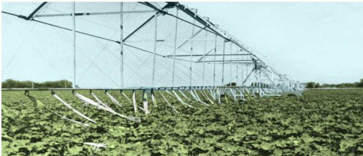
25- расм. Ғўзани эгатлаб суғоришда «Кубань» ёмғирлатиб суғориш машинасидан фойдаланиш.
