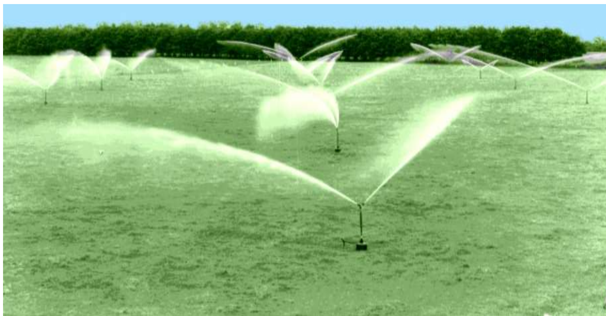
30- расм. Бедани синхрон-импульсли ёмғирлатиш суғориш комплекти (КСИД-10А) билан суғориш.
