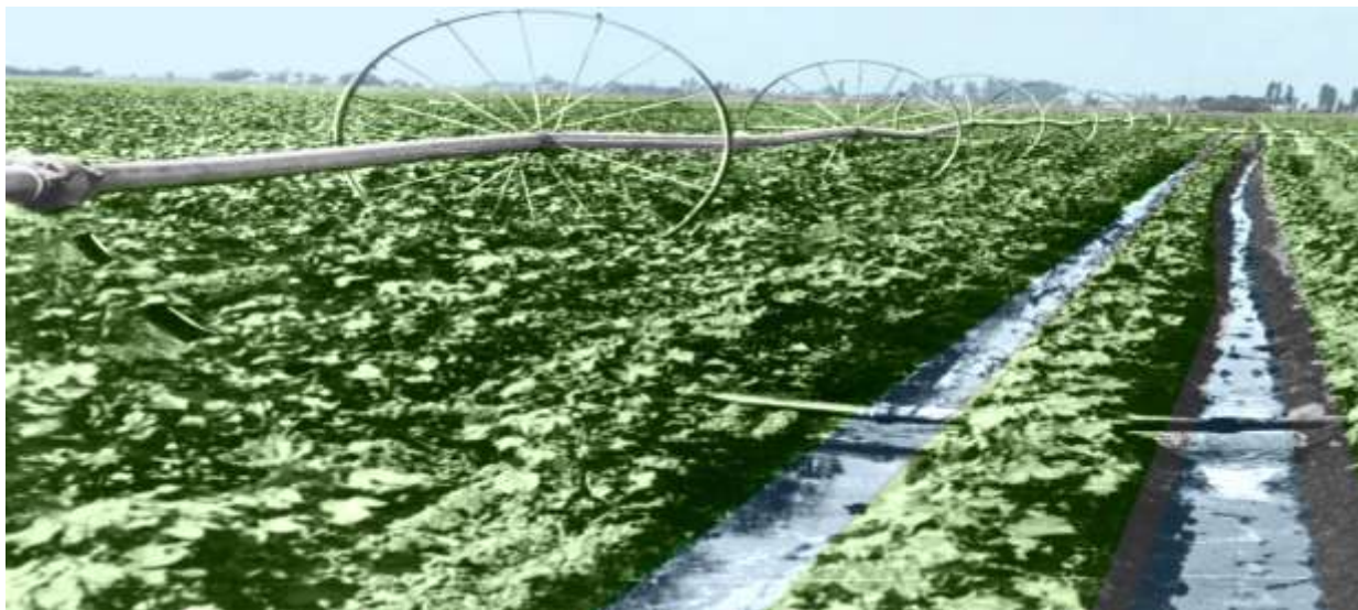
27- расм. ДКШ-64 «Волжанка» ёмғирлатиб суғориш машинаси.
