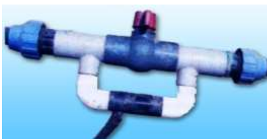
35- расм. «Вентури» типдаги инжектор ўғит эритмасини
