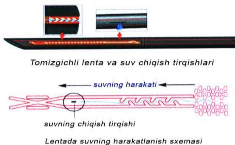
47- расм. Томизгичли лента ва унда сувнинг ҳаракати.
